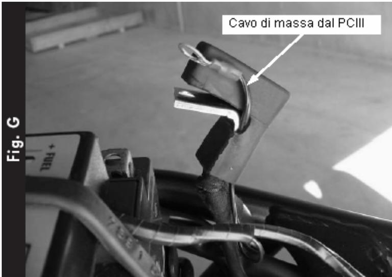
16) Svitare la vite del cavo di massa dalla batteria (terminale negativo).
