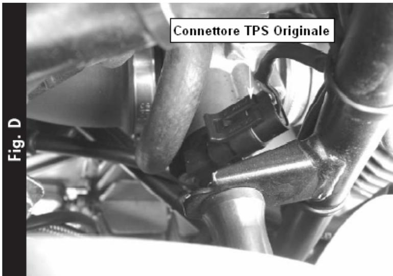
10) Localizzare il connettore del sensore TPS (posizione farfalla). Questo connettore si trova nel lato sinistro della moto fra il telaio ed il corpo farfallato (Fig. D).
