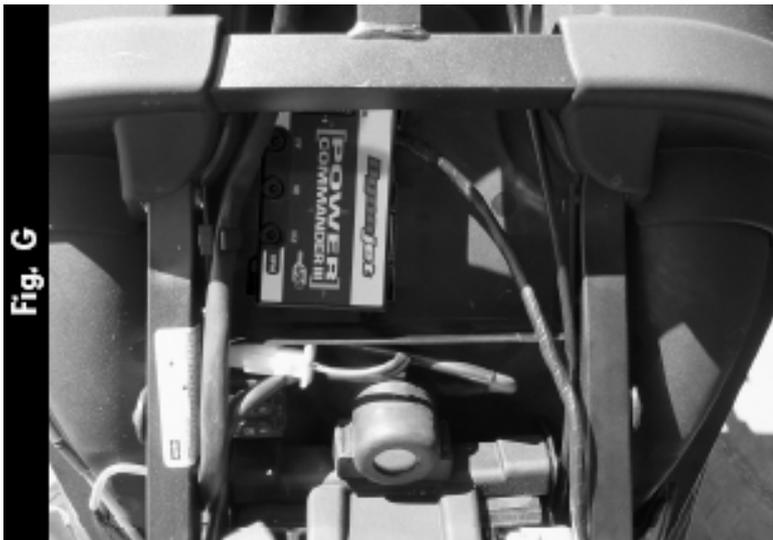
10) Posizionare il PCIII sotto il kit attrezzi in dotazione alla moto. Se non si utilizza il kit attrezzi, fissare il PCIII con il velcro fornito (Fig. G). Prima di applicare le parti adesive pulire bene entrambe le superfici con la salvietta in alcool fornita.
