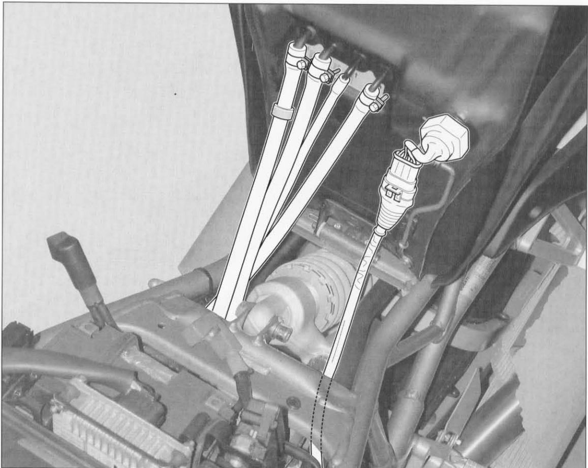
**Posizionamento cablaggio lato sinistro**      **Arrangement of LH wiring**
