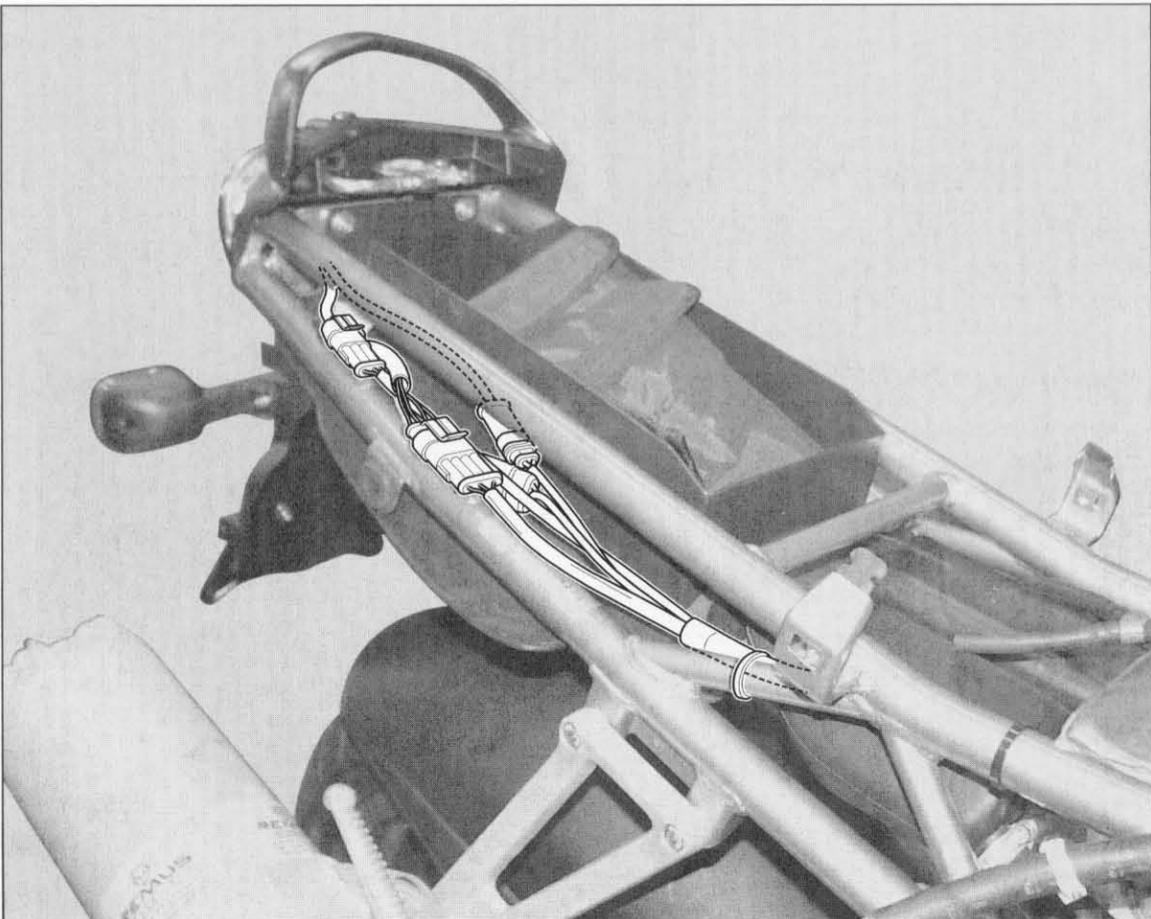
**Posizionamento cablaggio portatarga e indicatori di direzione**
