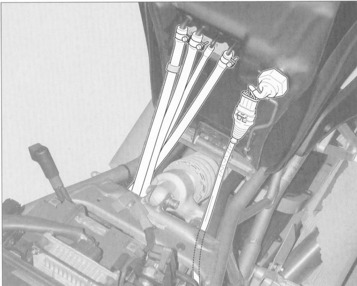
**Posizionamento tubo frizione**      **Clutch hose routing**
