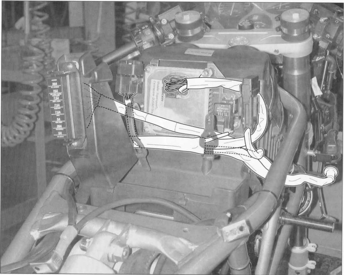
**Posizionamento tubi serbatoio sonda livello carburante**
