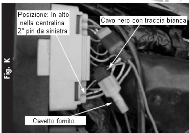
L'alimentazione del Power Commander normalmente è presa dall'impianto luci del gruppo ottico posteriore. Su alcuni modelli Europei è possibile escludere l'accensione delle luci tramite il comando sul manubrio. Questo provoca la mancanza dell'alimentazione del Power Commander e causa lo spegnimento della moto.
