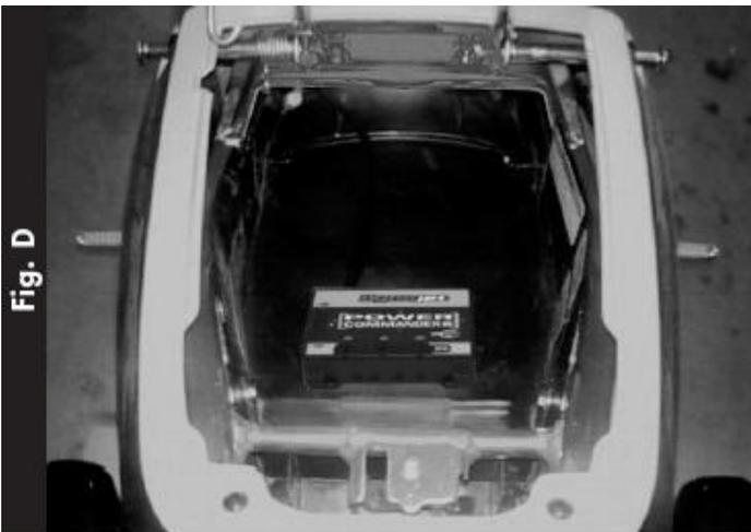
11) Fare scorrere il PCIII e il cablaggio sotto al telaio reggi sella passeggero. Fissare il PCIII sotto la sella passeggero utilizzando il velcro fornito (Fig. D).
