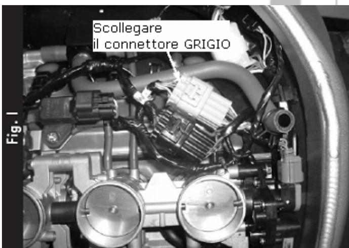
10) Scollegare il connettore del TPS (sensore di posizione farfalla). Questo connettore è di colore GRIGIO si trova più avanti del corpo farfallato e sopra al coperchio delle valvole (Fig. I).
