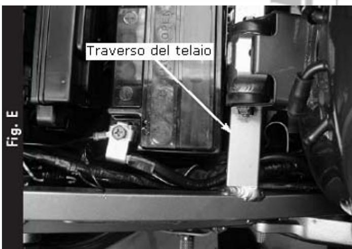
6) Far scorrere il cablaggio sotto al traverso del telaio (Fig.E). Rimuovere la batteria permetterà di avere più spazio per far passare i connettori e il cablaggio.
