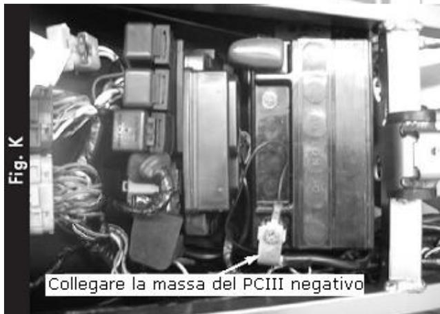
12) Collegare il cavo di massa del PCIII al terminale negativo della batteria (Fig. K).
