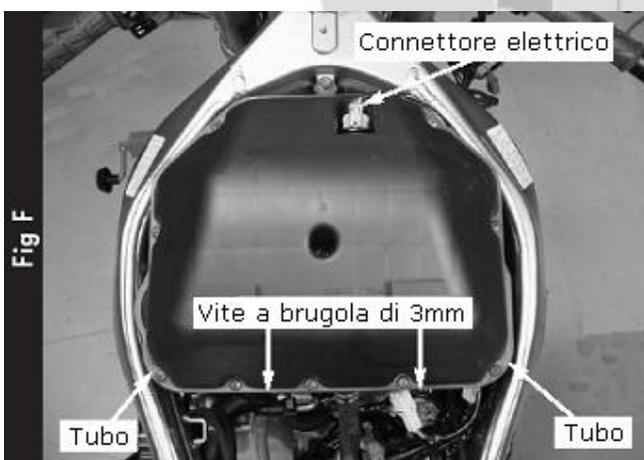
7) Sollevare il serbatoio e rimuovere l'airbox. Per rimuovere l'airbox occorre allentare le due viti nel retro dell'airbox con una brugola di 3mm (Fig. F). Scollegare inoltre i due tubi in gomma e il connettore elettrico indicati nella Fig. F.
