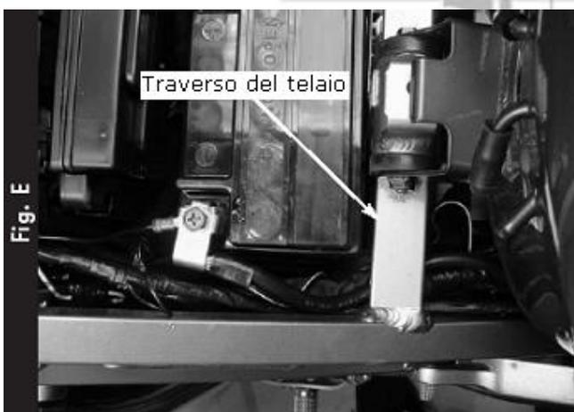
6) Far scorrere il cablaggio sotto al traverso del telaio (Fig. E). Rimuovere la batteria permetterà di avere maggior spazio per far passare i connettori e il cablaggio.
