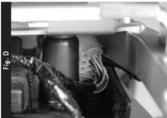
5) Far scorrere i connettori, uno alla volta, fra il telaio ed il sottosella (Fig. D).
