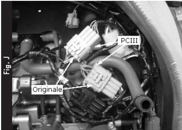
11) Collegare gli altri connettori del PCIII in linea con i connettori del TPS (sensore di posizione farfalla) originali (Fig. J).
