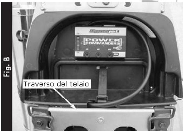
3) Estrarre il portaoggetti dal sottosella. Per rimuoverlo, svitare la vite che si trova nel centro del sottosella (Fig. A). Far scorrere il cablaggio del PCI II sotto il traverso del telaio e attraverso l'apertura nel sottosella (Fig. B).
