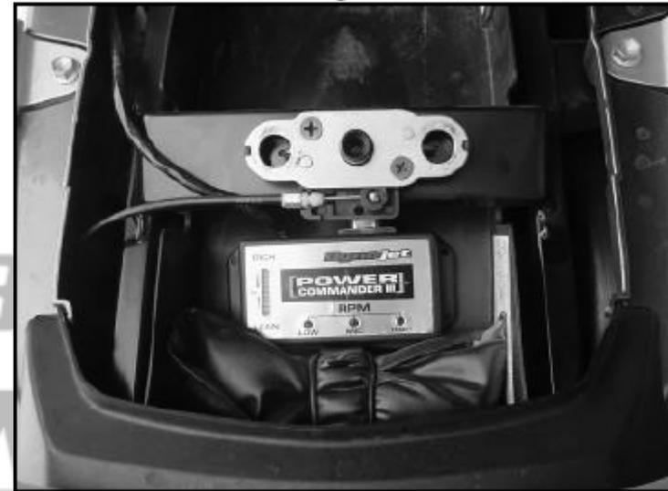
6) Collegare il cavo di massa dal PCIII al terminale negativo della batteria (Fig. E).
