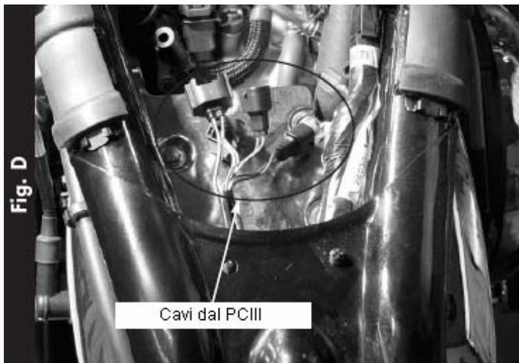
6b) Vista ravvicinata del cablaggio dal PCIII (Fig. D).
