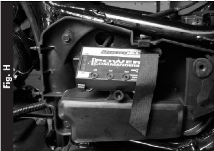
15) Fissare il PCIII nel vano portaoggetti in plastica sotto al coperchio laterale sinistro (Fig. H).
