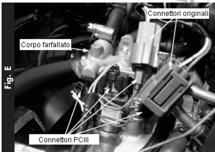
7) Collegare il connettore femmina del PCIII con il filo di colore ARANCIONE/BIANCO sull'iniettore anteriore (Fig. E).
